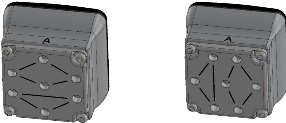
Um die Adapterplatte zu montieren, entfernen Sie einfach die vier Beschläge oder Blindschrauben vom Greifer, positionieren Sie die Adapterplatte im für die gewünschte Konfiguration passenden Winkel und ziehen Sie die vier Schrauben mit 4 Nm Anzugsdrehmoment fest.
